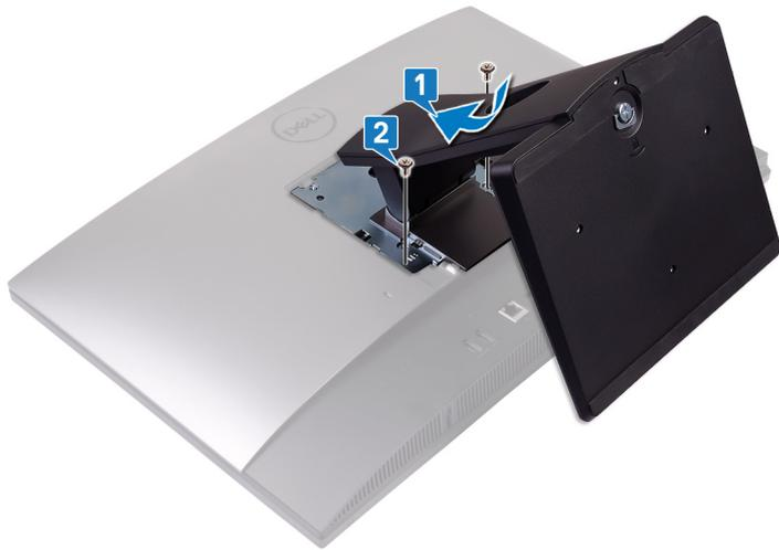
3 Deslice las lengüetas de la cubierta de la base por las ranuras de la cubierta posterior.
