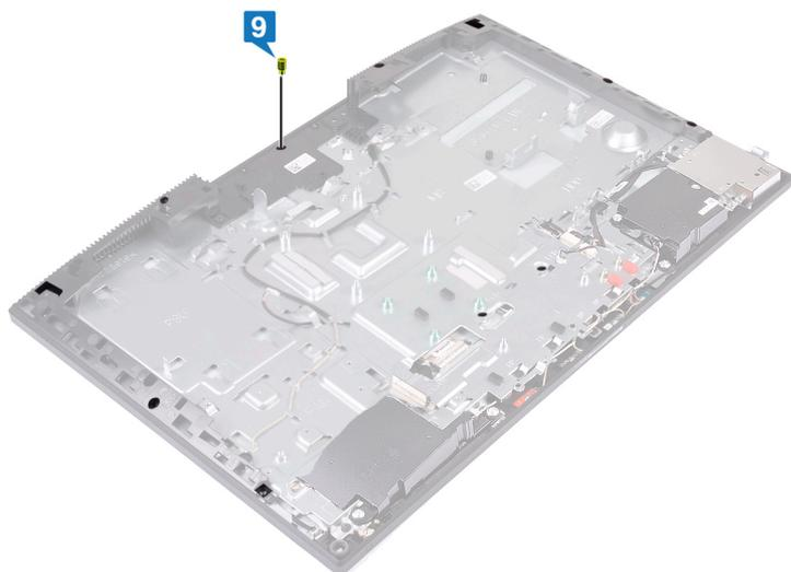
10 Vuelva a colocar el tornillo (M3x5) que fija el panel de la pantalla a la estructura intermedia y a la base del ensamblaje de la pantalla.
